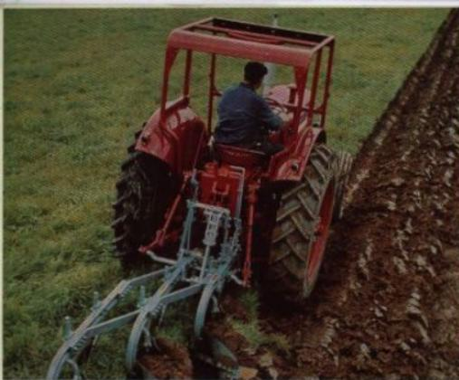
Boxer 350 har Terra-Trol hydrauliskt system, som ger jämnaste plåningsdjup oavsett markytans och jordens beskaffenhet. Terra-Trol ger också automatiskt maximal tyngdöverföring från redskapet till traktorns drivhjul. Motorns stora segdragningsförmåga ger Boxer en obändig styrka, när det verkligen tar emot. Stora drivhjul och differentialspår minskar i hög grad slirningen.
