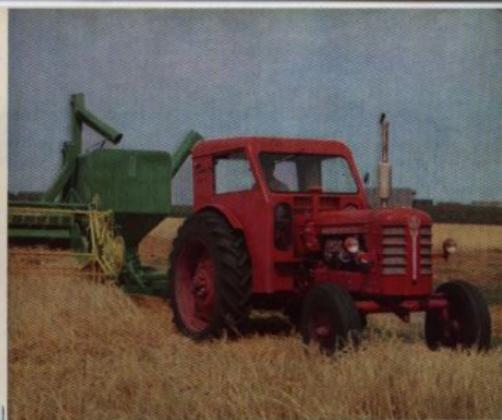
Boxer 350 är den idealiska traktorn för skördetröskning. Drakroks- och kraftuttagseffekten är mer än tillräcklig även för 6 fots skördetröskan. Det helt oberoende kraftuttaget underlättar i hög grad arbetet och skonar kraftöverföringen – traktorn kan stannas och även växlas om utan att detta påverkar driften av skördetröskan. — Bilden visar Boxer vid skördearbete i Frankrike.
