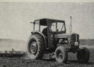
Boxer 350 är en idealisk jordbruks traktor tack vare robust konstruktion, lång hjulbas, stora hjul, differentialspärr och liten vändradius. Den store dragkraften – över 4.500 kp – och motorns erkänt goda segdragningsförmåga gör att Boxer med lätthet drar stora redskap och att avverkningen kan hållas hög.
