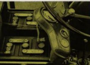
Helt inbyggda batterier, lättåtkomliga för kontroll. Buster 400 har "rena" sidor, vilket hög grad underlättar montering av redskap och utrustning. Förarens sikt är perfekt.
