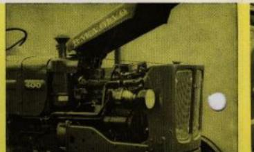
Ny 47 hk, ettrig dieselmotor med direktinsprutning — lättstartad, bränslesnål — med stor segdragningsförmåga. Elutrustningen — 12 volt — är av fabrikat Bosch med 130 W generator, 4 hk startmotor och 160 Ah batterier.
