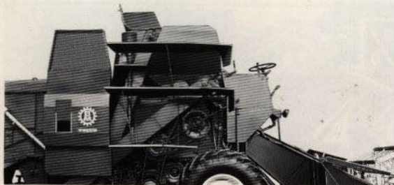
Uppfällbara luckor över transmissioner och smörjtälén.
