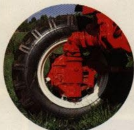
Fjädrande framaxel med överbelastningsskydd. Hög markfrigling (64 cm). Automatisk differentialspär.
