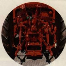
Två extra dubbelverkande hydrauluttag. Hitchkrok med svängbart jordbruksdrag för att nämna några av fineserna.
