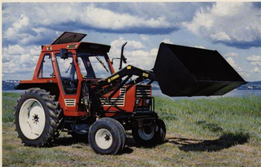
TRIMA 910. Dubbelverkande lyftkolvar, hydraulisk redskapsmanövrering.
