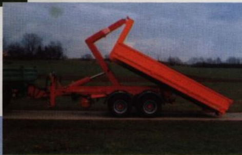
Flaket dras upp på chassiramen för transportläge.
