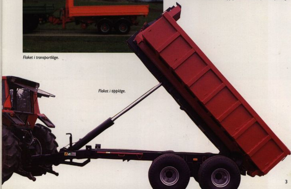
Flaket dras upp på chassiramen för transportläge.
