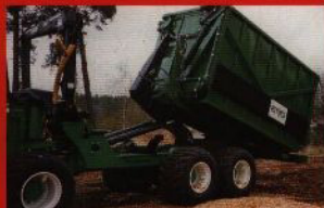
Lastväxlare på skotrar för flistransporter.
