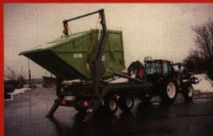
Liftdummersystem på lastbärarramar för skärgårdstransport av sopcontainer.
