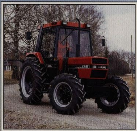
Den centrumdrivna framaxeln ger hög markgång. Dessutom har hjulbasen förlängts.
