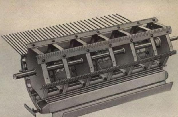
Tröskorganen på CLAAS PROTECTOR är 1.25 m breda, vilket ger maskinen ett utomordentligt „svälj“. Utrörskningen är optimal då spannmålen tillförs tröskorganen i ett tunt skikt. Kärnavskiljningen är utmärkt även vid långsträiga och fuktiga grödor. Till detta bidrar i hög grad tröskcylinder. Det är även sörjt för en problemfri körnaretrust-
