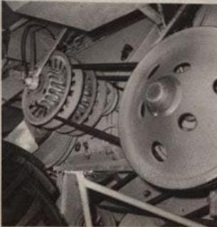
Tröskcylinder på CLAAS PROTECTOR drives av två körremmar. Denna transmission ger en säker driften även vid högsta belastningar. Varvtalet ställs in över en variator, vilket kan ske även under full belastning. Inställningen sker steglöst på hydrauliskt väg. Varvräknaren på instrumentpanelen anger exakt inställda varvtalet.
