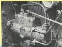
2 Lätt utbyttbar insprutningspump med centrifugalregulator av C.A.V. fabriken
