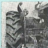
15 Bakhjulsskärmar, som sträcker sig ned till fotplattformen, skyddar föraren från smutsstänk
