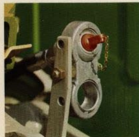
Det enkla tryckoljeuttaget, standard på alla traktorer.
