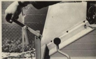
Från förarplatsen manövreras snabbstoppet för kniv och inmatningskruv.
