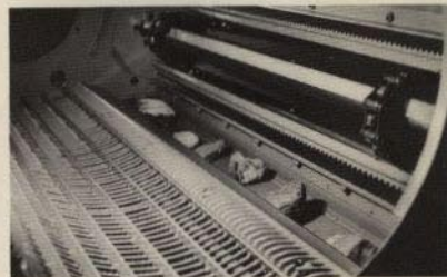
Den effektiva stenfickan är placerad framför tröskorganen för att skydda cylinder och slagsko.
