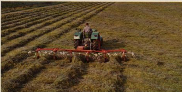
Strängläggning med KH 60
