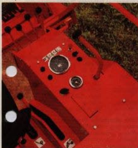
Instrumentpanel och hydraulikreglage
