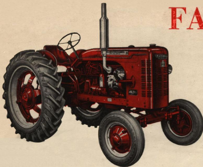
Fyrcylindrig, fyrtakt-heldieselmotor med förkammarsystem, toppventiler, femlagrad vevaxel, Bosch insprutningspump och bränslesystem.
