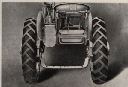
Hjulen inställda på smal spårvidd, 1016 mm. Spårvidden ändras genom att vända hjulen.
