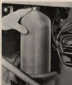
Filtret i oljeraren behöver utbytas först efter 120 arbetstimmar.
