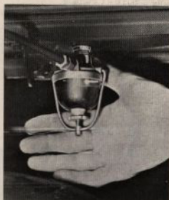
Bränslerenaren är av den vanliga i marknaden förekommande typen med glasskål.
