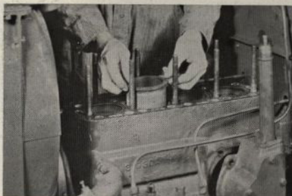
Ett cylinderlopp som blivit slitet kan för en ringa kostnad med lätthet utbytas.
