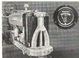
Kylargallret är på bilden borttaget för att visa den justerbara kylarljuslinsen. Värmenätaren är placerad ovanpå motorhuvens och lätt synlig från förarsätet.
