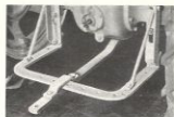
Den "svängande" dragbommen, som ingår i standardutrustningen, är praktisk vid t. ex. uttagande av tvåra svängar. Den kan på sättas den ordinarie dragbommen.
