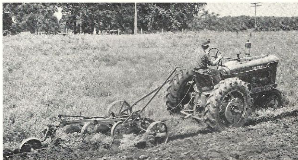
Farmall-M drager med lätthet en 3-skårig 14" plog. Avverkningskapaciteten blir med en sådan plog ända upp till cirka 15 tunnland per dag
