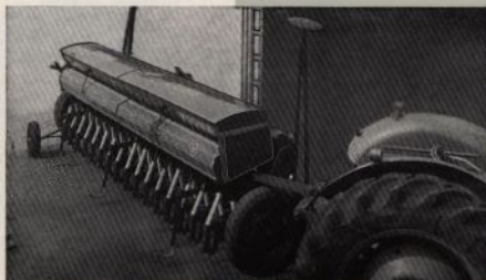
Såmaskin med påmonterad transportanordning - lätt att montera av för en man.
