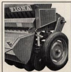
Gödnings- och frösåapparat i nedfällt läge för tömning.
