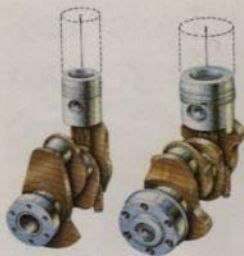
Skilnad: kortare kolstöd vid lågt motorvarvtal
