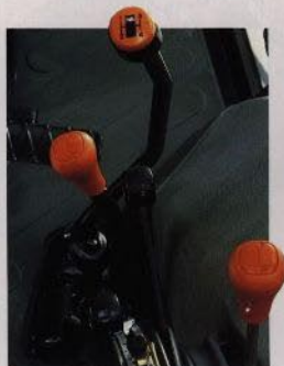
Dual Power snabbväxel manövreras med strömbrytaren på huvudväxelspaken
