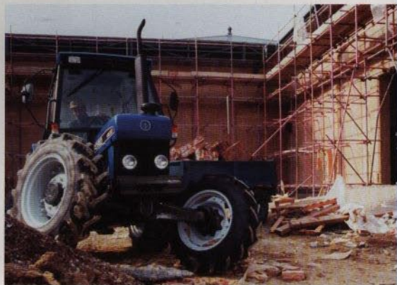
Den robusta framaxeln är godkänd för belastningar upp till 2267 kg.
