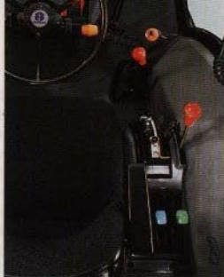
Dual Power snabbväxel manövreras med strömbrytaren på huvudväxelspaken.
