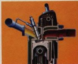
▼ Cylinderlock av tvärströms-typ – nu ytterligare förbättrat för effektivare förbränning.
