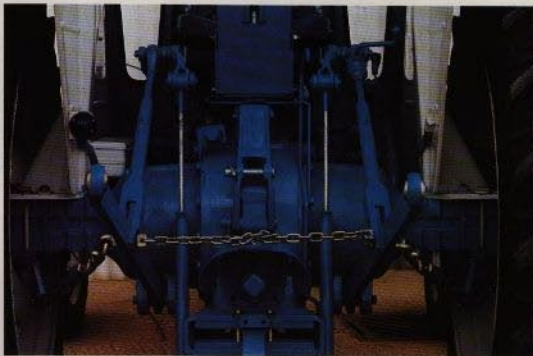
▲ Tre-punkts upphängning för kategori 1 och 2 redskap med dubbelverkande toppstång. Klarar tunga redskap med lätthet.
