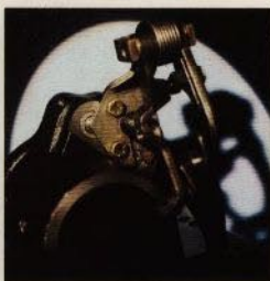
▲ Ny, fjädrande ventil ger jämnare och mjukare korrigeringar av redskapet.
