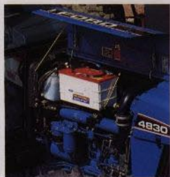
Speciell kolvform, högt vridmoment, stor diameter på insugningsröret, gör att den fyrcylindriga motorn utvecklar 48 kW (65 hk)
