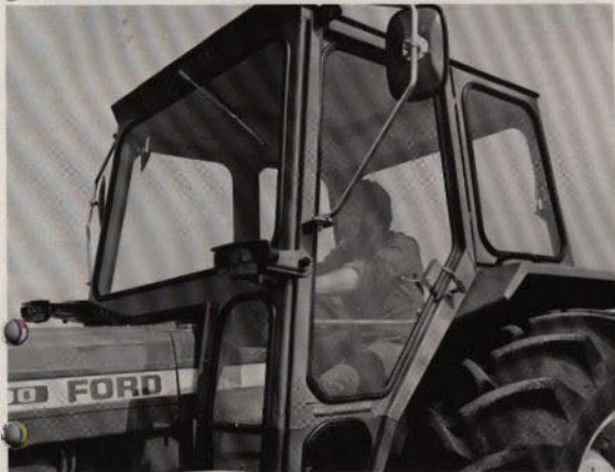
▲ Den öppningsbara fönstren ger justeringsmöjligheter inifrån hytten.
