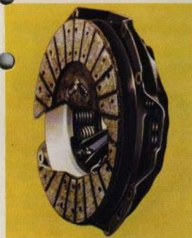
▲ Slitstark, enkel lamellkoppling med 304mm (12 tum) diameter. Jämn och mjuk inkoppling och dessutom lågt pedaltryck.
