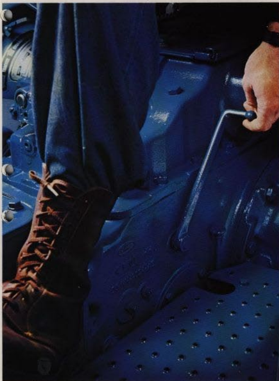
▲ Kraftuttagsaxeln kan lätt roteras när motorn har stannats, vilket underlättar tillkoppling av kraftuttagsdrivna redskap.
