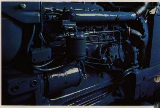
▲ Kraftigt cylinderblock med djupt neddragna sidor och gavlär.
