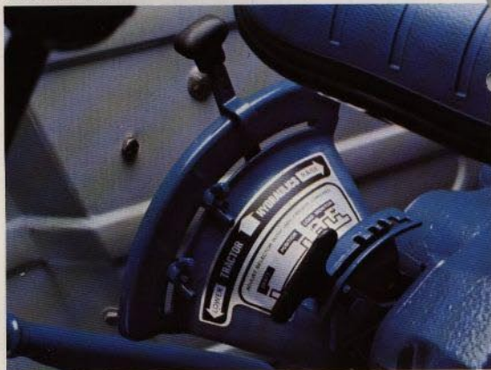
▼ Dragkrafts- och lägeskontroll väljes med ett enkelt handgrepp och hydraulsystemet manövreras med en enda spak. Bilden visar Ford 6600 specialutrustad med Load Monitor.
