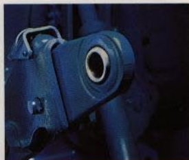
▲ Flexibla dragstångsändar och yttre begränsningskedjor.
