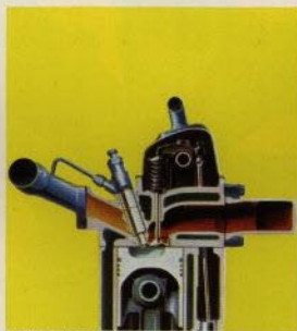
▲ Nytt cylinderlock med modifierade kanaler, ventiler och kompressionsrum, vilket ger fullständigare förbränning, renare avgaser och bättre ekonomi.
