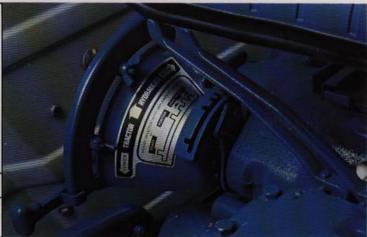
▼ Såväl dragkrafts-, läges- som Load Monitor-kontroll väljes lätt från förarplatsen.
