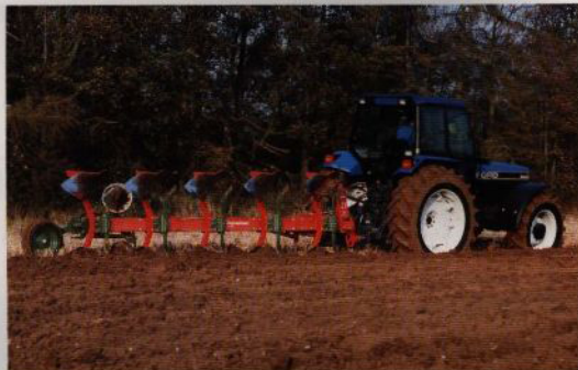
ElectroLink™ innebär bättre dragkraftskontroll, t.ex. på denna 8240 SLE med 80,9 kW (110 hk) motor.
