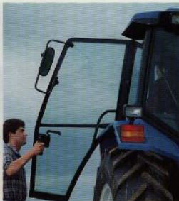
Dörrarna är formade i ett stycke av tonat glas. De förenar maximal sikt med kraftig konstruktion.
