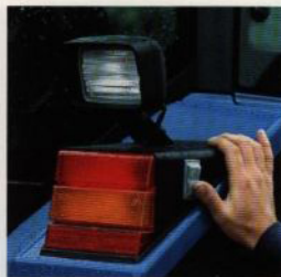
På bakskråmarna finns strömbrytare för utvändigt manövrering av dragarmarna.
