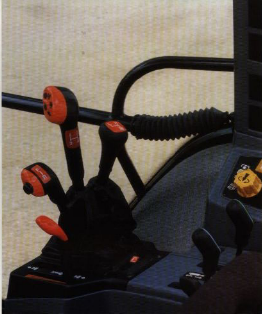
Ergonomiskt placerade växelspakar. Huvudväxelspaken (i mitten) har fyra växellägen samt två knappar för DualPower snabbväxel. Till höger sitter gruppväxelspaken och närmast föraren finns fram/back-spaken med sin frikopplingsknapp.
