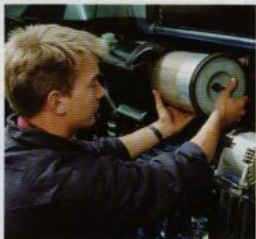
Alla filter - luft-, olje-, bränsle-, hydraul- och hyttfilter - är monterade för att underlätta kontroll och byte.
