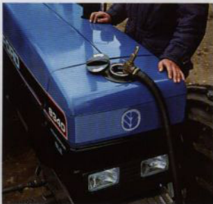
Den totala bränslekapaciteten uppgår till 218 liter. Bränslepåfyllningens konstruktion samlar upp spillt bränsle vilket håller traktorn ren.
