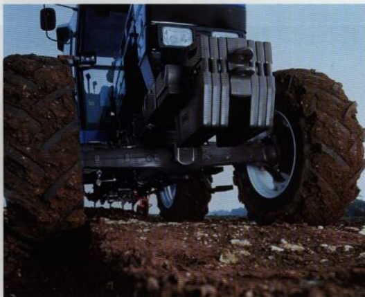
Framhjulsdriftens drivning är en del av själva växellådshuset. Detta förbättrar frigångshöjden och eliminerar behovet av drivknutar.
