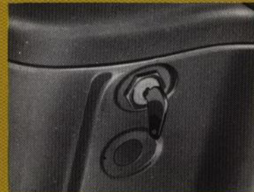
Motorns säkerhetsstart fungerar endast med växeln i friläge.
