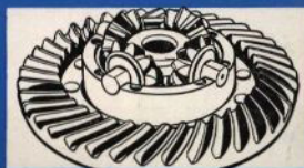
Kardanhjul och differential med fyra drev.
