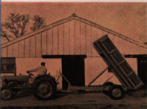
Stå ventil ger ett separat oljeuttag för t. ex. fippning, frontlastare o. dyl.
