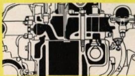
Insprutningssystemet kombinerar fördelarna av virvelkammare och direkt insprutning.
