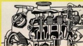
Toppventiler, som påverkas av vipparmarna. Ventilerna är lätta att justera.
