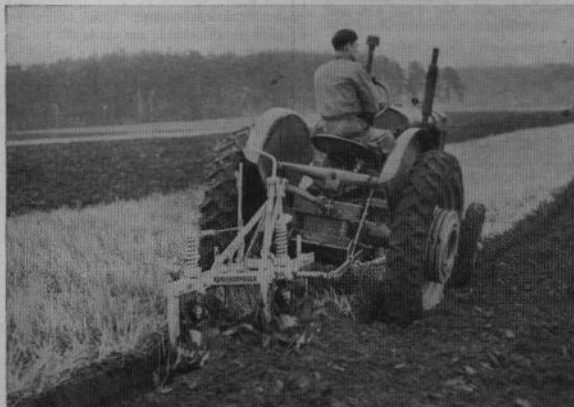
Fordson Major traktor med hydraulisk lyftanordning och 2-skårig 12" bärplog. Plogtyp: Sesam Junior. Med den hydrauliska lyften blir arbetet smidigare, bl. a. kan man backa ut med redskapet över diken och sålunda effektivt bearbeta vårdtegar och hörn.
