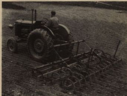
Sladdfjäderharvar, kopplade till Fordson patenterade redskapsram, vilken manövreras med den hydrauliska lyften.
