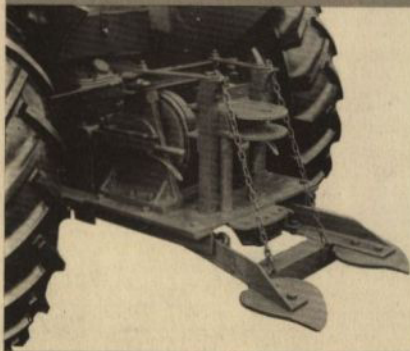
Vinsch (Darlington), dragkraft 5 ton.
