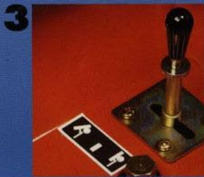
3 Rilasciamento idraulico posteriore o trilaterale con leva dotata di fermo di sicurezza.
