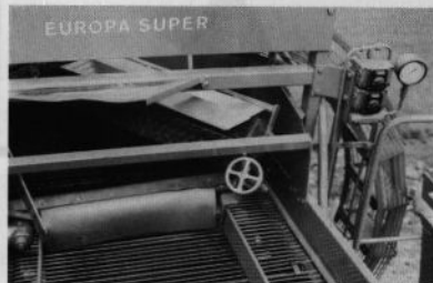
Frånskilningsaggregat SGBR hydro med borste. Med reglagen till höger regleras hastigheten dels på nylonborstvalsens, dels på gummimattan, sorteringsmattor och -valsar. Resp. hastigheter inställs steglöst. Helt oberoende av varandra och traktorns varvtal.
