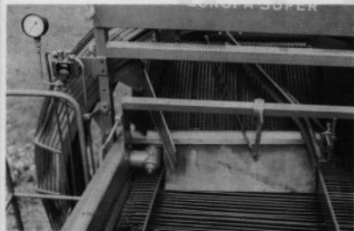
Frånskilningsaggregat SGBR hydro. Med reglaget till vänster regleras hastigheten på den piggförsedda gummimattan samt renbordets sorteringsmattor och -valsar. Detta sker steglöst och helt oberoende av traktorns varvtal.
