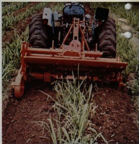
Ogräsbekämpning på sockerrörsfält i Empangeni, Zululand. Rotavator ur E-serien utrustad med rotor för radsådda grödor.
