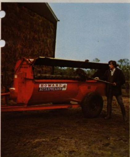
Modell 100 utrustad med speciell lucka för lastning för hand från sidan. Lagerföres ej i Sverige.
