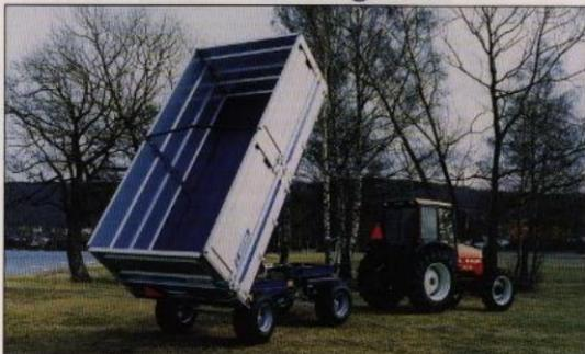
**Traktorvagn med 9-ton**s maxlast. Flakstorlek 432x216 cm. Lämmar 40 + 80 cm, de undre fällbara, de övre topphängda. Framstam 60+60 cm. Tömningslucka i nedre bakläm. Kullagrad vändkrans. Bladfjäderupphängd framaxel. Spårvidd 150 cm. Lasthöjd ca 115 cm. Lastvolym 11,2 m<sup>3</sup>. Tjänstevikt 2490 kg. Tippvinkel 55°. Totalbredd 222 cm. 40km/h.
