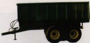
**Husqvarnas combivagn** med 12-tons lastförmåga. Helsvetsat containerflak 470 x 240 cm med 4 mm bottenplåt. Sidohöjd 130 cm i 3 mm plåt. Bakluckan är topphängd. Låsning sker med hydraulisk uppfällbar flaps som manövreras från traktorn. Spårvidd ca 175 cm. Lasthöjd 125 cm. Lastvolym 14,4 m<sup>3</sup>. Tjänstevikt 2900 kg. Tippvinkel ca 55 grader. Totalbredd 255 cm.
