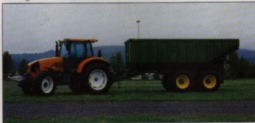
Husqvarnas högtippande fältvagn, speciellt framtagen för transport av rotfrukter på fältet. Helsvetsat containerflak 250 x 573 cm, med 14 tons lastförmåga. 4 mm's bottenplåt och 3 mm's i sidorna. Hydraulisk bakläm. Tipp höjd 2 m. Tippvinkel 80 grader. Spårvidd 190 cm. Lasthöjd 287 cm. Lastvolym 18 m<sup>3</sup>. Tjänstevikt 5000 kg. Totalbredd 260 cm. Totallängd 750 cm. Trumbromsar 450 x 150 mm. Däckdimension 600/55-26.5".
