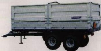
**Traktorkärra med 11-tons** maxlast. Boggie monterade hjul. Flakstorlek 432x236 cm. Lämmar 40 + 80 cm, de undre fällbara, de övre topphängda. Framstam 60 + 60 cm. Tömningslucka i nedre bakläm. Spårvidd 175 cm. Lasthöjd ca 109 cm. Lastvolym 12,2 m<sup>3</sup>. Tjänstevikt 2170 kg (2450 kg\*). Tippvinkel 55°. Totalbredd 242 cm. 40 km/h
