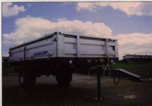
**Traktorkärra med 4-ton** maxlast. Flakstorlek 370x206 cm. Lämmar (50) + 30 cm. De undre fällbara och de övre (30 cm) typ till satslämmar. Bakåttipp. Obromsad. Spårvidd 150 cm. Lasthöjd ca 94 cm. Lastvolym 5,3 (6,1) m<sup>3</sup>. Tjänstevikt 1120 kg. Tippvinkel 46°. Totalbredd 212 cm. Godkänd för 40 km/h då traktorns egenvikt överstiger 4270 kg.
