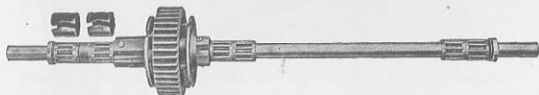
Den tudelade huvudaxeln hos slåttermaskinen DEERING med spärrhakarsskivorna utdragna. Observera de dubbla rullagren, på korta axeldelen löpande i utbytbara stålhylsor.
