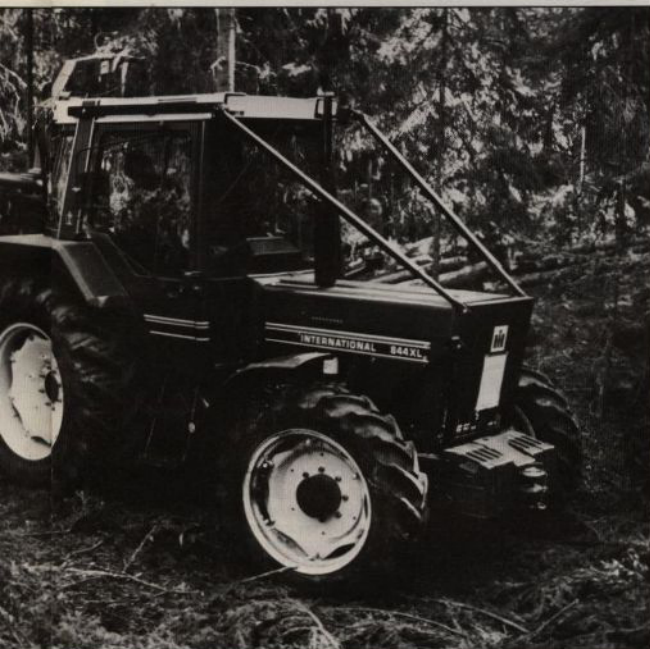
I skogen får den vanliga jordbrukstraktorn ofta mycket "stryk". Vill man undvika dyra reparationskostnader finns bara ett sätt - skydd!
