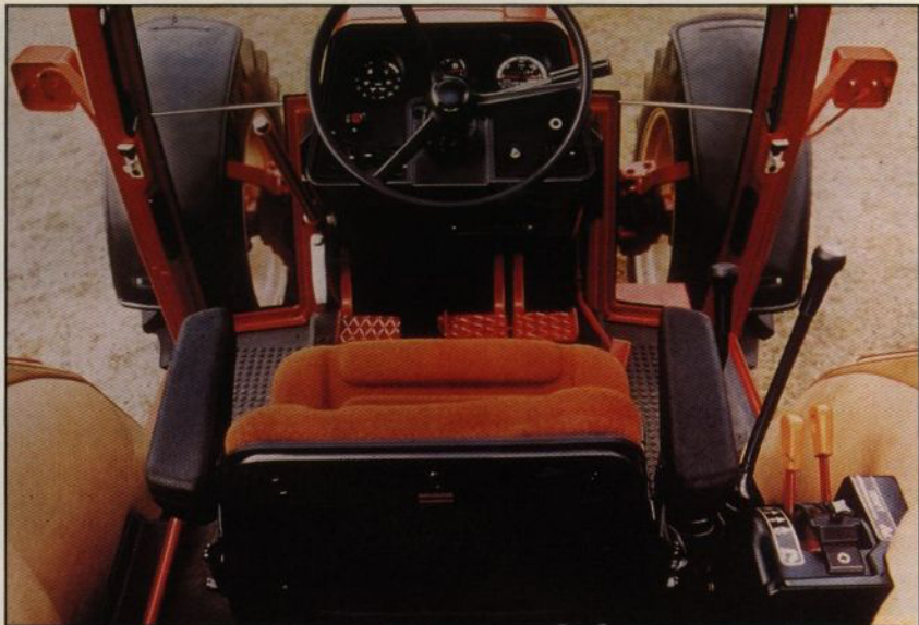
De nya XL-hytterna är konstruerade för maximal komfort. Rymliga utan besvärliga pedaler och reglage som hindrar insteget, bra sikt, lågt ljud.
