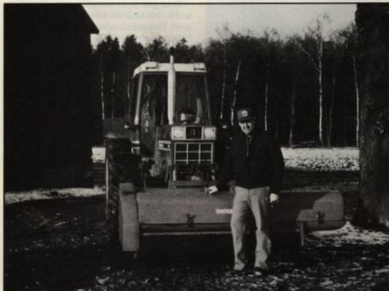
Inspektör Lennart Svensson tillhör dem som börjat tänka "på längden". Med hydraulik i fronten gör den här traktorn dubbelt arbete - blästaggregat fram, betupptagare bak.
