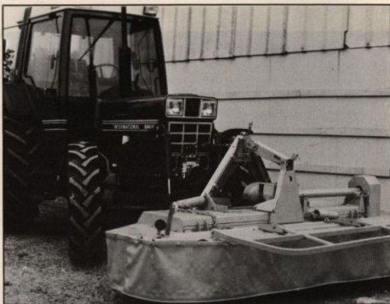
Det nya tänkandet – redskap i båda ändarna på traktorn i stället för allt bredare. På bilden en rotorslättermaskin i fronthydrauliken.
