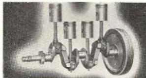
Den kraftiga 3-lagrade vevaxeln är oerhört stark, focco-härdad och med barrade hål för trycksmörjning av såväl huvudlager som vevstakslager.
