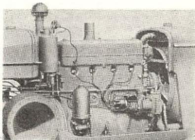
Bilden visar högra sidan av den starka topptvårcylindermotorn på W-9-traktorn. Synliga äro bland andra detaljer bensintanken (för start), oljerensaren, smagalen och den 4-bladiga fläkten. En oljepump av kugghjulstyp pressar oljan till huvud- och vevstakslager, vipparmar m. fl. Motorn är lätt åtkomlig för inspektion och eventuella justeringar.
