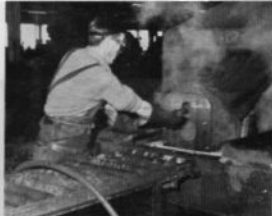
De nygjutna traktorkropparna tvättas flera gånger med ånga i en speciell maskin innan de går vidare till monteringsbanan.
