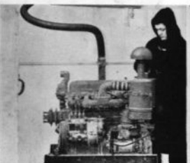
Kallstart av en Farmall-motor i "Arktiska rummet". Det gäller att vara väl påklädd här.
