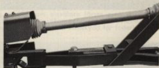
FÖRLÄNGNINGSDRAG användes vid självlastning tillsammans med upphängningsanordningen för JF slaghack. Vagnens kraftöverföringsaxel kopplas härvid direkt till upphängningens växellåda.
