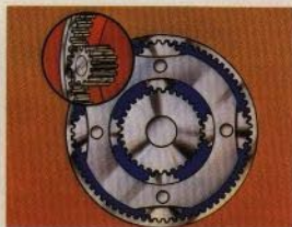
Slutväxlarna är av planettyp. Här fördelas kraften över tre drev: det ger styrka, tyst gång och tillförlitlig kraftöverföring.
