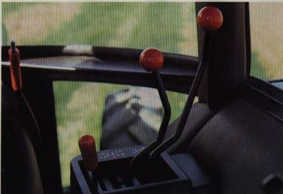
Växelspakarnas placering till höger om dig gör jobbet bekvämt. Du har två spakar: en för gruppväxelläge, en för både hastighet och Hi-Lo.
