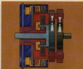
Den synkroniserade växellådans växlar fördubblas med hjälp av Hi-Lo-snabbväxellådan. Det blir lätt att välja rätt växel för varje jobb.
