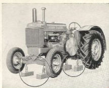
Vibrationsfri gång: Traktorn uppställd på fyra bushor med full fart på motorn bevisar att John Deere-motorn är väl utbalanserad.
