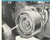
Frictionskopplingen i remskivan, 12H Åtkomlig från utsidan. 5 min. för justering, 15 min. för utbyte av lamell.
