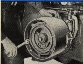
Friktionskopplingen i remskivan, lätt åtkomlig från utsidan. 5 min. för justering, 15 min. för utbyte av lamell.
