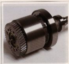
Den mycket hållbara framhjulskopplingen är konstruerad för att överföra höga vridmoment till framhjulen.
