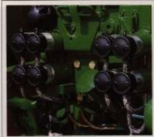
Hydrauloljeventilerna är utrustade med snabbkopplingar i vilka slangar kan kopplas eller dragas av under tryck.
