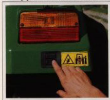
Utvändiga strömbrytare (extrautrustning) på de bakre stänkskärmarna underlättar tillkopplingen av redskap.
