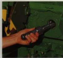
Kraftuttagsaxeln kan vändas utan oljespill.
