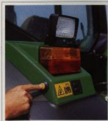
In- och urkoppling av kraftuttaget kan även utföras från den bakre, vänstra stänkskärmen (extrautrustning). Detta är speciellt fördelaktigt vid manövrering av direktdrivna specialredskap.
