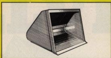
GRUSSKOPE 600 liter, bredd 1,5 meter. Botten av stålplåt. Utbytbar slättstål.
