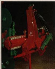
Vändhuvud 110 passar för mindre traktorer med tre-skärig växelplög. Marknadsförs ej i Sverige.
