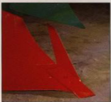
Knivrist, alternativ till skivrist. Mycket effektiv på extremt halmrika tegar. Samma placering som tidigare, men den skär någon cm utanför landsidan och minskar dragkraftsbehovet jämfört med skivrist med 10 %. Vid plöjning på vall och på seg lerjord gör dock skivristen ett bittrare arbete.
