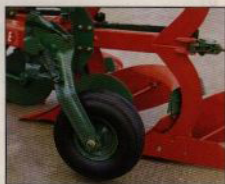
Extra stöd hjul i massivt gummi för "lättare" bogserade plogar.
