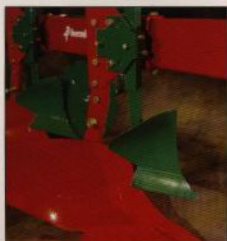
Skumrist (brett skär) monteras på plogisen. Rekommenderas vid plöjning av vall och obearbetad stubb.
