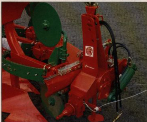
Extra stöd hjul i massivt gummi för "lättare" bogserade plogar.
