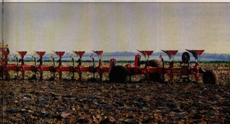
Kvernelands bogserade växelplog modell PX/RX. Storlekar 8-12 skär.
