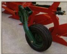
Extra pumpbart stöd hjul i gummi för "tyngre" bogserade plogar.
