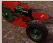
Kombinerat, styrbart stöd- och transporthjul i gummi, pumpbart. För att underlätta hanteringen av större plogar vid transport och på vändtegar.
