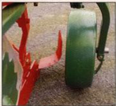
Färbreddare skär av en "extra bit" och lämnar en öppen och bred körlåra med rejält utrymme för bredhjul. Enkel montering på tidigare modeller.
