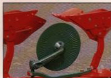
Skivristar finns i flera utföranden för att passa olika jordars behov.
