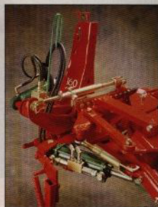
Vändhuvud 160 är avsett för växelplögar med upp till fem skär och för traktorer från 70 till 180 hkr.
