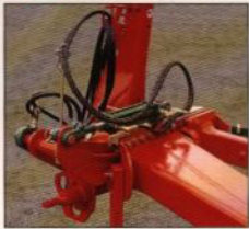
Hydraulisk sidoreglering för inställning av första tilläns bredd. Finns till fiertelet modeller (standard på AB-plogen och växelplögar med Variomat-systemet). Hydraulisk sidoreglering kräver ett dubbelverkande hydrauluttag.
