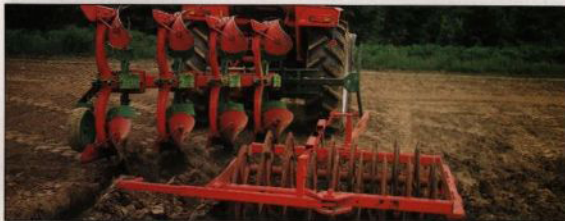
De båda fångstarmarna som samtidigt utgör drag, är förbundna med varandra medelst en kedja och "det gamla draget" fälls därför automatiskt in i nytt uppfångsläge (i bild baktill på tiltpackaren).
