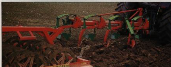
På tegplogar monteras en dragarm som står i förbindelse med kropp 2 till vilken dragkedjan kopplas. Här följer tiltpackaren med upp på vändtegen.
