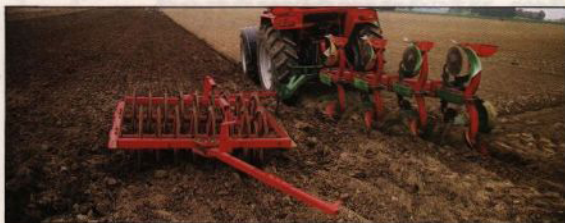
Tiltpackare vid plöjning med växelplög: Vid vändtegen släpper man packaren genom att lyfta plogen, lämnar tiltpackaren "i samma riktning", vänder och fångar in tiltpackaren i den andra fångstarmen när plogen går i jorden.
