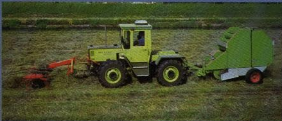
Med frontmonterad strängläggare kör man inte i fodret och jordinblandning och förluster undviks.
