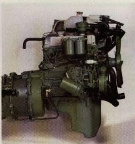
MB-trac 900 är utrustad med den robusta dieselmotorn OM 364.
