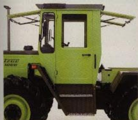
Som extrautrustning kan även öppningsbar framruta erhållas.
