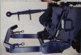
MB-trac har en sidostabil frontlyft med pendelutjämning och variabel längd.
