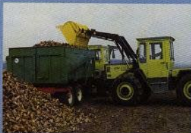
Hög kapacitet med frontlastare tack vare lättgående servostyrning och en kraftig arbetshydraulik. De självcentrerande fästpunkterna för lastaren finns som standard.
