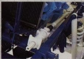
Oberoende kraftuttag med varvtalen 540 och 1000/min är standard både fram och bak. Inga slirkopplingar begränsar effektuttaget.
