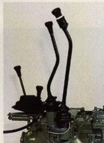
Växellådorna är tätstegade och synkroniserade både framåt och bakåt.
