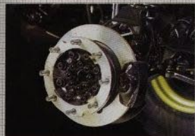
MB-trac har bromsar med stor dimension på alla fyra hjulen.
