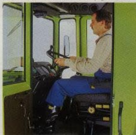
Komfortsitsen är avfjädrad och hydrauliskt dämpad. Sidolutningen är ställbar liksom även armstödet, ryggsstödet och sittyta.
