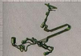
Styrningen på MB-trac har ett eget oljesystem.
