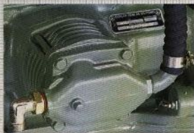
Den på motorn fast monterade kompressorn ger hjälpeffekt åt bromsanläggningen — underhålls- och påfyllning.
