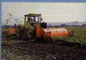
Den kraftiga frontlyften bär tunga redskap utan problem — krafterna leds direkt till ramen.
