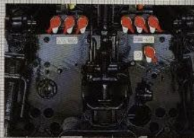
Fram och bak kan upp till sex hydraulanslutningar samt separata, tryckfri returledning monteras.
