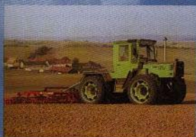
Med dubbelmontage på båda axlarna minskar marktrycket ytterligare.
