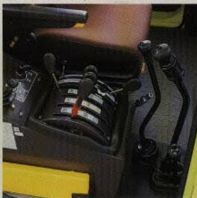
Manöverspakarna för växellåda, hydraulik, fyrhjulsdrift och differentialspär är placerade till höger om förarstolen.
