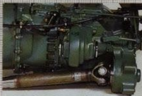
Direkt, fast drivning av framaxeln.
