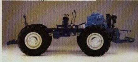
Ramen — den starka ryggraden i MB-trac.
