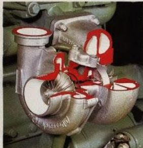
Mer luft, mer syre, bättre förbränning tack vare turbon i OM 364 A.
