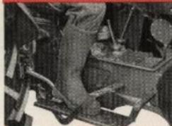
Differentialspärren sammankopplar bakaxlarna och differentialen. Båda bakhjulen kommer därigenom att rotera med samma hastighet. Spärren inkopplas med en fotpedal.
