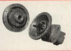
Slutväxlarna är av typen planetväxlar med 3 planetjul. Planetväxlar ger tystare och jämnare gång eftersom alltid mer än ett kuggingrepp erhålls.
