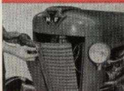
Kylmaskeringen är lätt borttagbar och innanför denna finns, förutom kylaren, luftrenaren samt en oljekylare för det hydrauliska systemet. Luftintaget är placerat i traktorns front.
