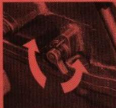
Inställning av reaktionshastigheten sker med ett reglage på hydraulhusets högra sida. Med detta kan en anpassning av hydraulsystemets reaktionshastighet under vitt skilda arbetsförhållanden erhållas.
